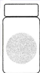
圖 44：裝有 1.5mL 有機混合物的 20mL 液態閃爍計數瓶中的過濾材料（25mm）（由於過濾器僅被潤濕，因此它被固定在液態閃爍計數瓶內壁上的理想測量位置。） 2002 年
